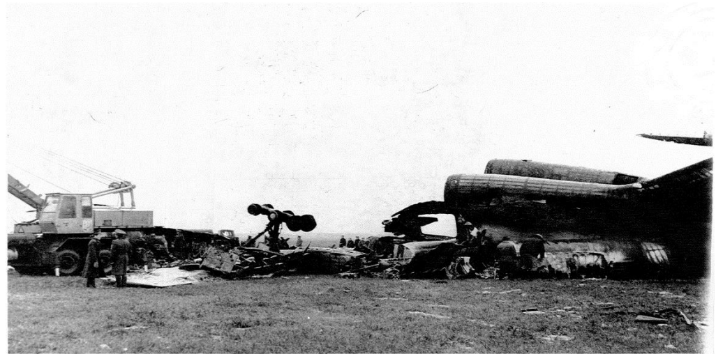
Фото № 3 Правая ОЧК с опорой шасси.
